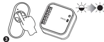
3 Нажать и потом отпустить первую кнопку передатчика (движение ▲). Зажжется (мигающий сигнал, после постоянного) красный диод LED.
