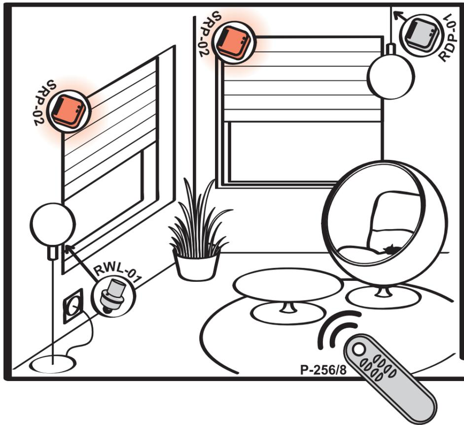
Система управления рольставнями, реализованная при помощи контроллеров рольставней SRP-02. Один контроллер может использоваться только для одной рольставни. Каждый из контроллеров запускается дистанционным пультом P-256/8. Пульт управления работой встраиваемого радиодиммера RDP-01 (управление вкл/выкл и осветление/ затемнение источника света) а также радиовыключателя освещения RWL-01.
