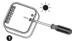
1 Нажать кнопку PROG устройства SRP-02 и удерживать ее до загорания (постоянный сигнал) красного диода LED. Отпустить кнопку PROG.
