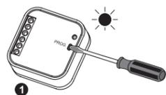
1 Нажать кнопку PROG устройства SRP-02 и удерживать ее до загорания (постоянный сигнал) красного диода LED. Отпустить кнопку PROG. Подождать (около 5 с) пока диод LED зажжется (мигающий сигнал, а потом постоянный).
