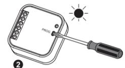
2 Нажать кнопку PROG устройства SRP-02 и удерживать ее до загорания (постоянный сигнал) красного диода LED. Отпустить кнопку PROG. Подождать (около 5 с) пока диод LED зажжется (мигающий сигнал, а потом постоянный).
