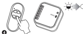
4 Нажать и потом отпустить вторую кнопку передатчика (движение ▼). Диод LED зажжется (мигающий сигнал), а потом потухнет – ПЕРЕДАТЧИК ЗАПИСАН.
