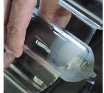
газопоглотитель разрушен, трубка неисправная
