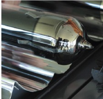
газопоглотитель в порядке, трубка исправная
