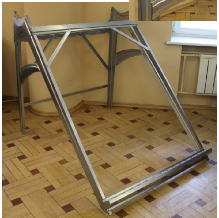
Конструкция стальной рамы (к окрашенному баку) →
