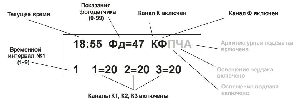
Рис.3. Отображение информации на дисплее контроллера
