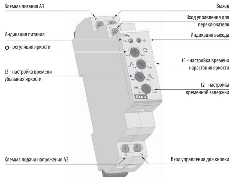
Рекомендации при установке: с каждой стороны устройства необходимо оставить пространство мин. 0.5 ширины модуля, т.е. 9 мм для лучшего охлаждения.
