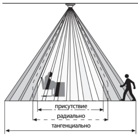
Надежное распознавание присутствия существенно зависит от количества, свойств и расположения элементов линзы. IR Quattro имеет квадратную зону охвата в  $49 \text{ m}^2$ , которая подразделяется на 13
