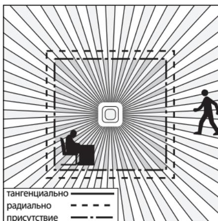
потребностям. За счет квадратной зоны охвата и возможности объединения вариантов Master/Slave в сеть обеспечивается простое, быстрое и оптимальное планирование помещения.
