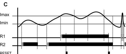
После превышения значения I<sub>min</sub> контакт R2 замкнут. После превышения значения I<sub>max</sub> замыкается контакт R1. Контакт R1 блокируется до нажатия кнопки RESET. При значении превышающем I<sub>max</sub> контакт R1 не реагирует на RESET.
