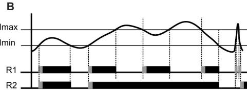
После превышения значения I<sub>min</sub> контакты R1 и R2 замкнуты. После превышения значения I<sub>max</sub> размыкается контакт R1, а R2 остается замкнутым.
