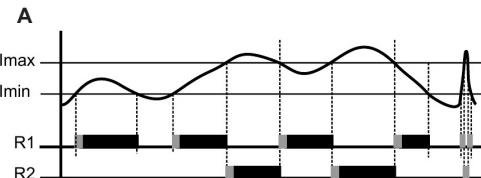
После превышения значения I<sub>min</sub> контакт R1 замкнут. После превышения значения I<sub>max</sub> замыкается контакт R2, а R1 размыкается.
