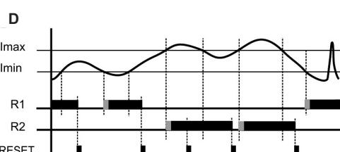
После превышения значения I<sub>min</sub> контакт R1 замкнут. После превышения значения I<sub>max</sub> замыкается контакт R2, а R1 размыкается. Контакты R1 и R2 блокируются до нажатия кнопки RESET. При значении превышающем I<sub>max</sub> контакт R2 не реагирует на RESET.
