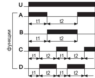
**Задержка выключения (A):** после подачи напряжения питания контакты переключаются в положение 1-6, 2-7 на время t1. По окончании времени t1 замыкаются контакты 1-5 и 2-8 на время t2. По окончании выдержки времени t2 контакты переключаются в положение 1-6, 2-7.
